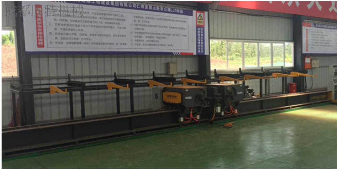
四机头数控钢筋弯曲中心为满足客户的多功能要求而研制开发，是数控双机头立式钢筋弯曲中心的升级版本，在两个弯曲主机的基础上又增加了两个移动式弯曲主机，并相应增加的储料、输料的长度；一般用于铁路、公路、电力、市政、桥梁和预制等建设领域。1. 弯曲和行走均采用品牌伺服电机驱动，确保设备运行稳定，控制加工精度在1mm以内。2. 钢筋中间夹紧机构采用气缸夹紧，气动结构后期故障率低，使用寿命长。4. 钢筋加持机构采用柔性钢筋锁紧机构，保证在夹紧钢筋的同时不损伤钢筋。5. 行走采用齿条齿轮啮合传动方式，保证了机头行走稳定性，行走尺寸更加准确。6. 采用齿轮二级减速结构，使传动方式更加稳定，缩短设备中心距，保证可满足更多图型加工；7. 采用PLC控制系统，放入钢筋后可直接弯曲，缩短机头行走浪费的时间。8. 操作系统具有柔性安全保护功能，保证设备在误操作后尽量不会损伤器械。4、配置自动机械手装置。四川钢筋弯曲数控钢筋弯曲中心联系方式
